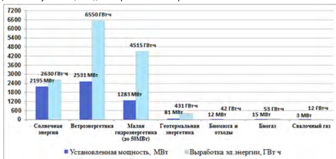
Рисунок 3.6 Установленные мощности и выработка электрической энергии в России на основе ВИЭ в 2023 году (По данным АРВЭ)
